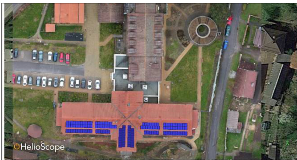
Střecha objektu s návrhem umístění FVE panelů
